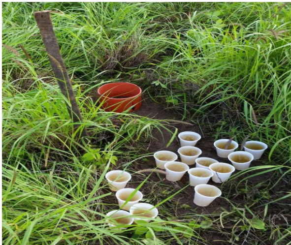
Figura 2. Determinação da velocidade de infiltração básica de água no solo.
