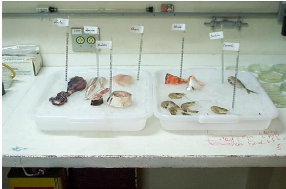
Figura 5. Armazenamento semelhante às condições do supermercado (amostras sobre o gelo picado)
